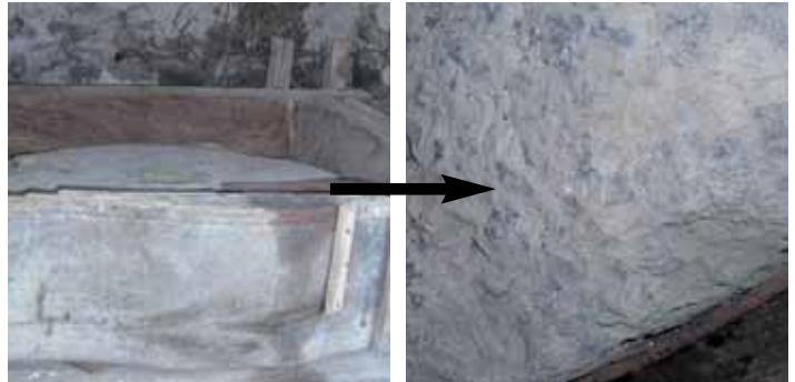
Fig. 6 et 7 Meule en grès grossier pour la farine de maïs au moulin de Peco Eyhera : la pierre n'est pas travaillée par rainure mais par piquage (technique plus grossière car il s'agit d'une farine de moindre importance).
