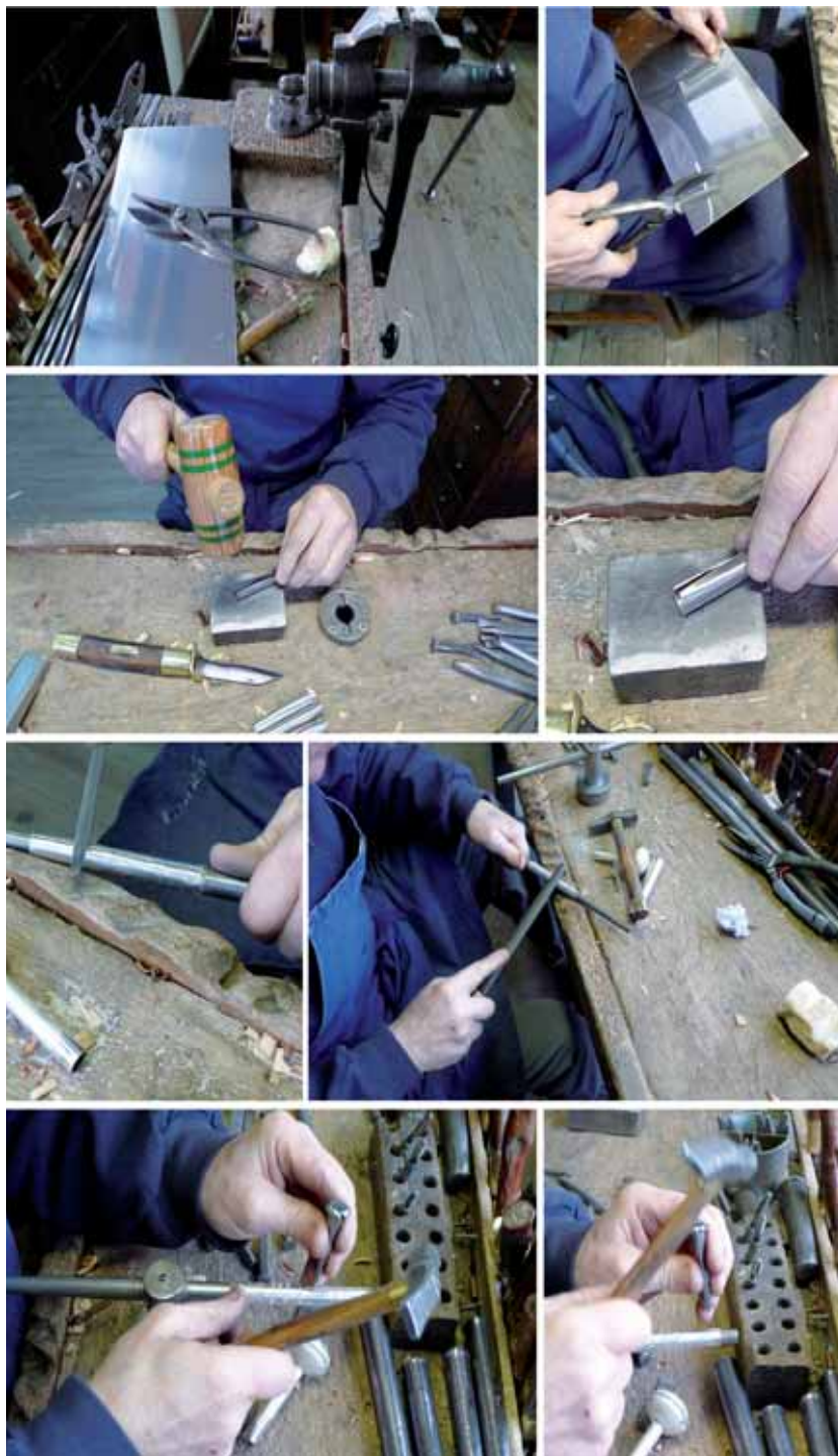
Fig. 1 Élaboration de la virole en argent d'un makhila d'honneur : tout se fait à la main, de la plaque de métal à la gravure. L'étape du brasage à l'argent pour fermer la virole n'est pas représentée ici. Cl. Ainciart Bergara
