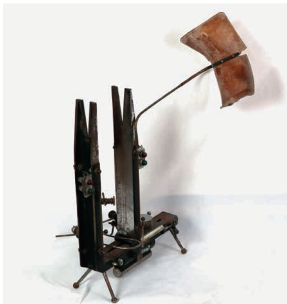
Fig. 6 Marcel BORTHAYRE (Arcangues, 1928 – Bayonne, 1999), Appareil de centrage des roues de vélo ou "dévoileur". Métal et cuir. H. 67 cm ; l. 40 cm ; L. 42 cm. Musée Basque et de l'histoire de Bayonne, inv. n° 2006.4.1. Don Maryse Borthayre en 2006.
