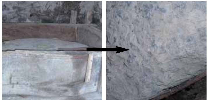
Fig. 6 et 7 Meule en grès grossier pour la farine de maïs au moulin de Peco Eyhera : la pierre n'est pas travaillée par rainure mais par piquage (technique plus grossière car il s'agit d'une farine de moindre importance).
