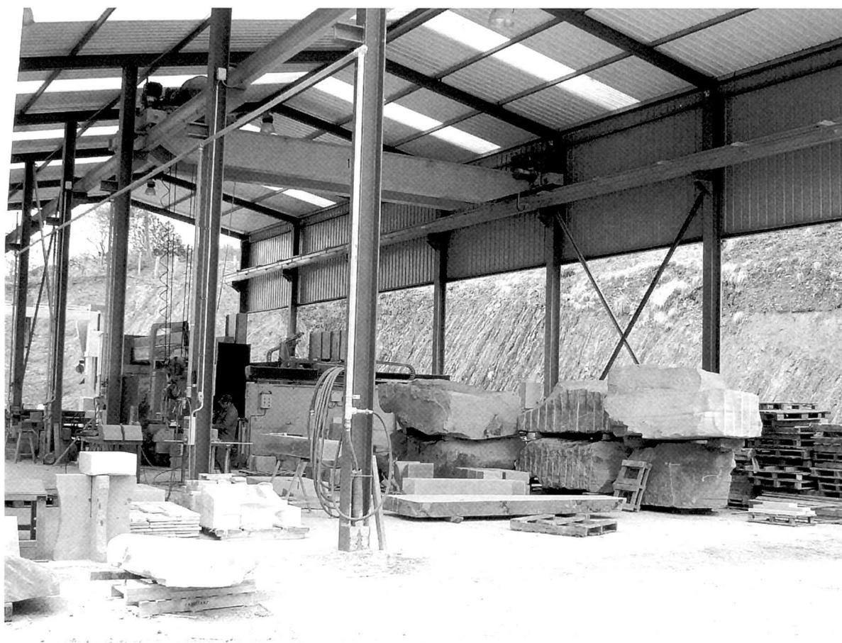
Fig. 10A : vue de l'entreprise (pont roulant avec quelques installations) ; au premier plan, à gauche, des pièces terminées, prêtes à être livrées.
