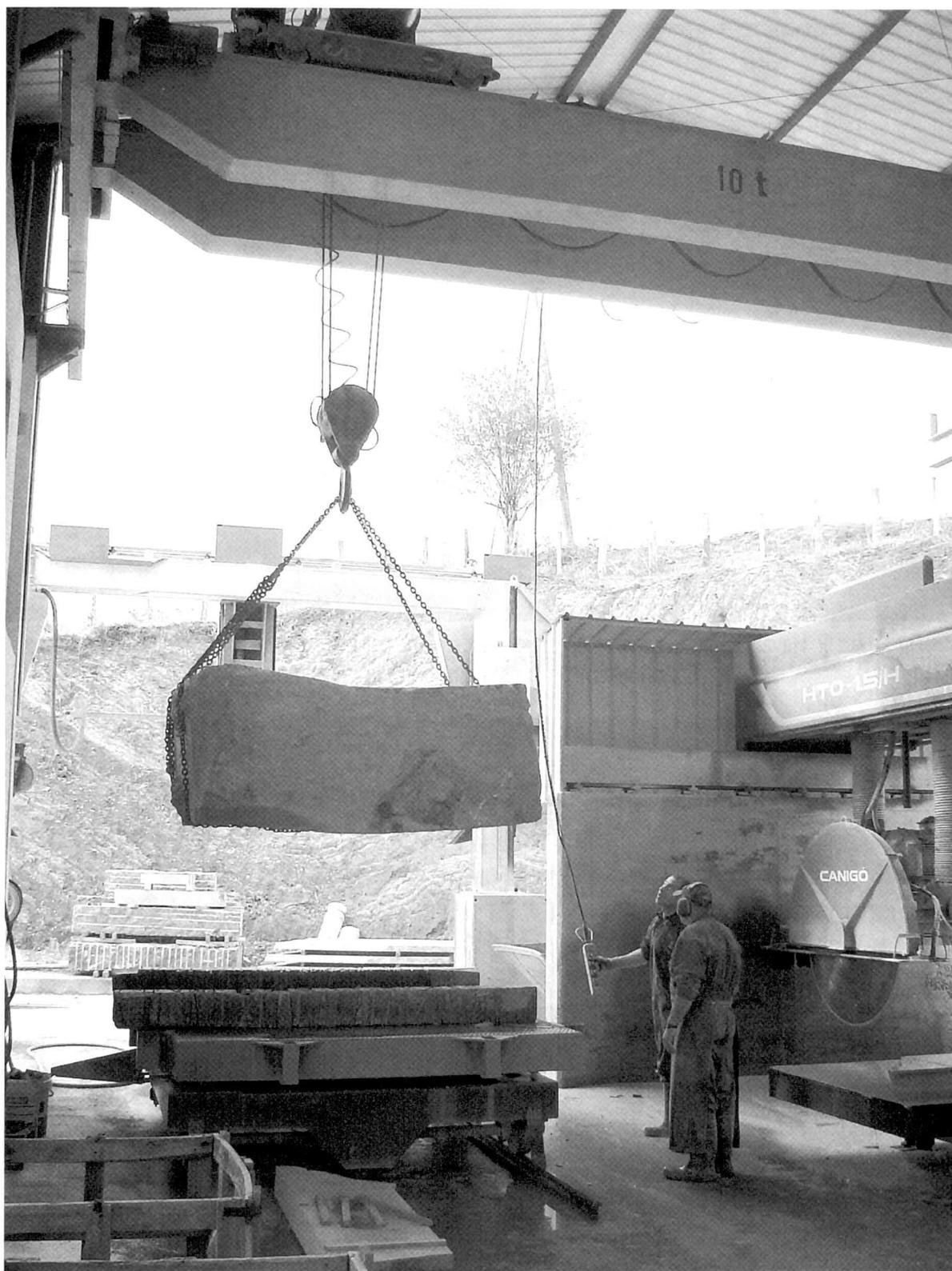
Fig. 10C : des pièces sont déchargées avec le pont roulant et les chaînes
