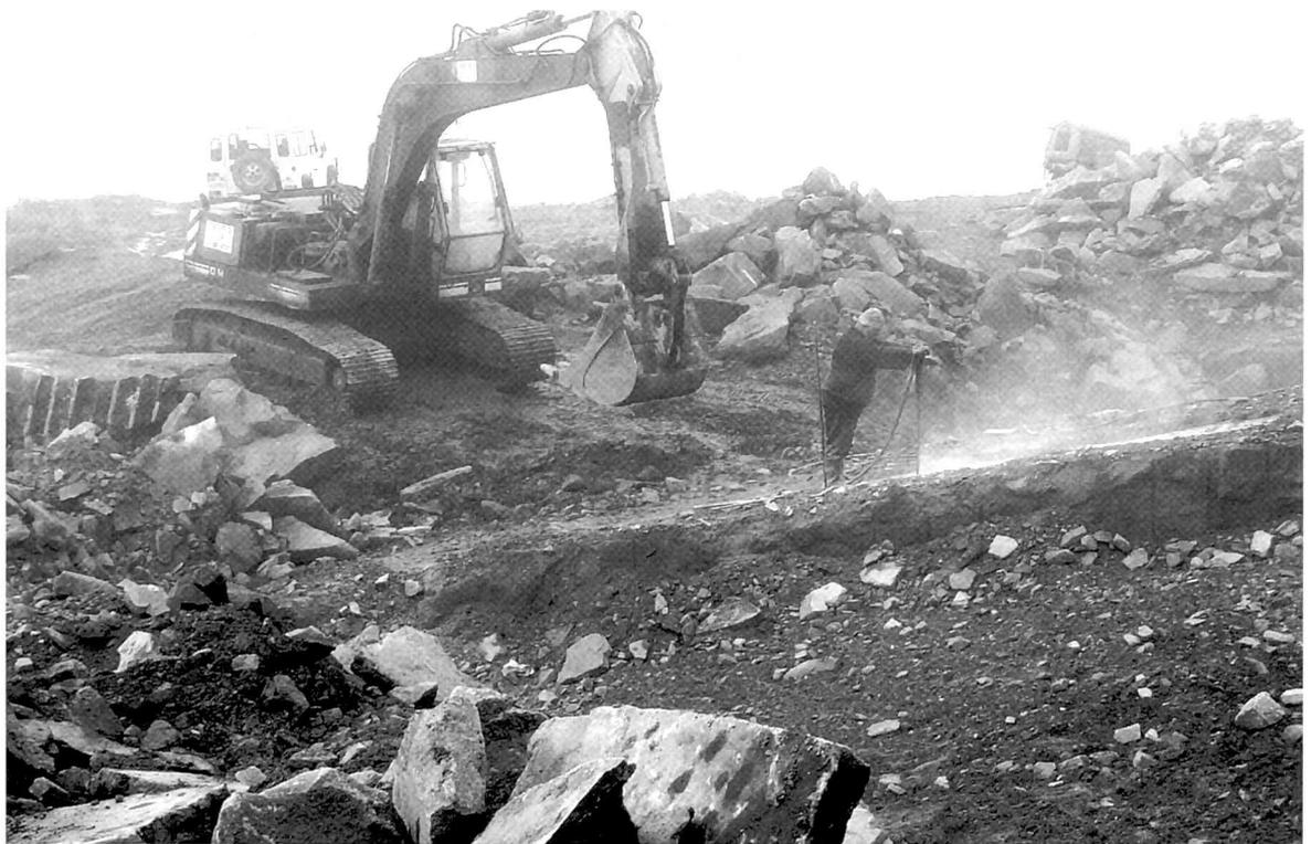
Fig. 6B : D. Goñi a mis à nu un banc de pierre utile (avec la pelle mécanique) et se prépare à en détacher un bloc en préparant des trous pour y enfoncer des coins expandeurs à trois pièces ou de l'expandeur chimique.
